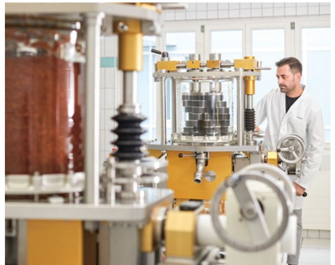
▲ Schonend und selber entwickelt: die mechanische Ceres-Pressen für Heilpflanzen.
